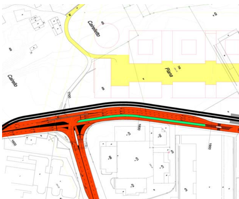
Fig.11: proposta di sistemazione dell'incrocio semaforizzato di Suglio
